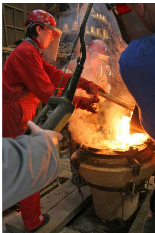
Coulée de la cloche des Invalides - Virginie BASSETTI enflamme les masselottes pendant la coulée - Photo Vincent M. ©
