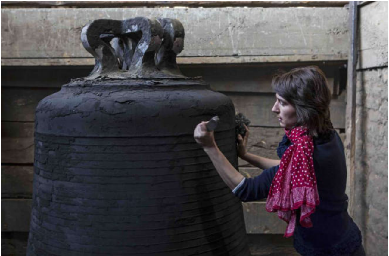
La cloche Gabriel sort noircie de son moule en argile qui a brûlé sur toute sa surface après la coulée du bronze en fusion
