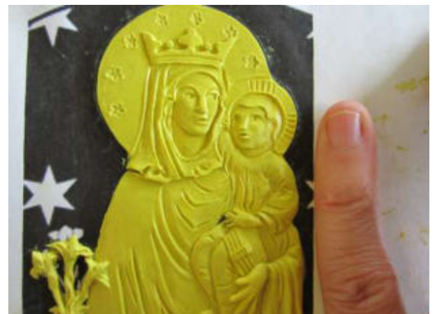
L'artiste a calé la définition de sa sculpture sur la capacité du fondeur à couler des détails plus ou moins précis. Ainsi, les détails des visages de la Vierge et de Jésus ne peuvent pas être plus précis sur ce type de cloche monumentale.
