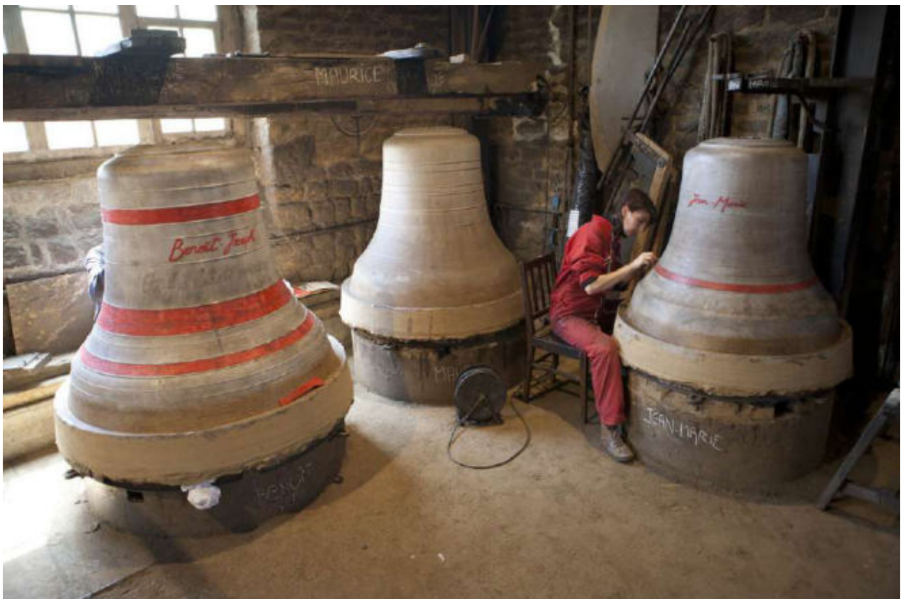
« Fausses cloches » (= modèles de cloches) en cire rouge et blanche dans l'atelier de moulage de la fonderie de Villedieu-les-Poêles – À droite sur la photographie : Virginie BASSETTI sculpte les effets de matière sur Jean-Marie – 5 juillet 2012
